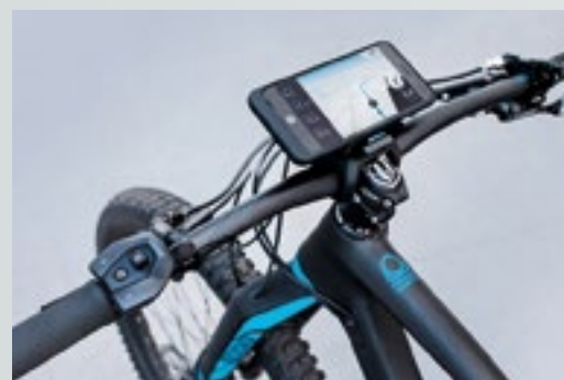
Contrôle via la commande déportée Bosch
